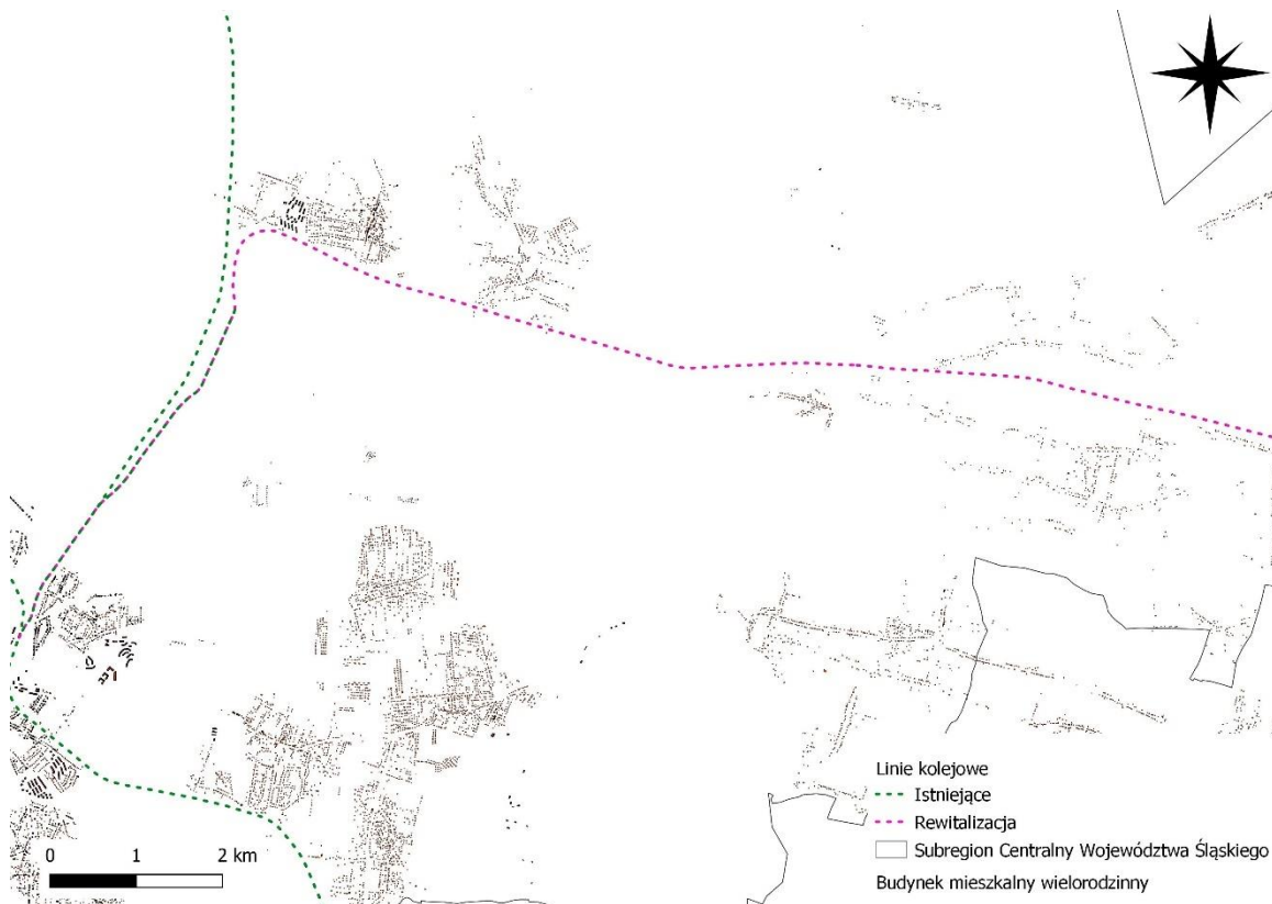
Rysunek 7.28. Istniejące oraz zaplanowane do rewitalizacji linie kolejowe na tle zabudowań mieszkalnych w rejonie Miasteczka Śląskiego
